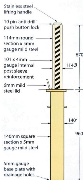
El bolardo **Rhino-Phantom** presenta un alto riesgo para la seguridad. Disponible en azul tráfico, negro, gris pizarra y rojo. Altura: 670 mm, diámetro: 114 mm. Longitud del eje: 960 mm. Peso: 55 kg. Peso operativo: 17 kg.
