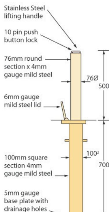
Bolardo **Rhino básico** para tráfico de bajo riesgo. Disponible en azul tráfico, negro, gris pizarra y rojo. Altura: 500 mm. Diámetro: 76 mm. Longitud del vástago: 700 mm. Peso: 22 kg. Peso en funcionamiento: 6 kg.
