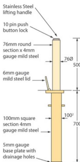
Poste de segurança **Rhino Básico** para tráfego de baixa intensidade. Disponível nas cores azul tráfego, preto, cinza ardósia e vermelho. Altura: 500 mm. Diâmetro: 76 mm. Comprimento da haste: 700 mm. Peso: 22 kg. Peso operacional: 6 kg.
