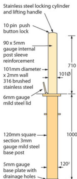
**Rhino-Bollard Corniche** para risco moderado de segurança. Disponível em aço inoxidável 316L escovado e com revestimento transparente. Altura 710 mm, diâmetro 101 mm. Comprimento da haste 1000 mm. Peso 40 kg. Peso operacional 17 kg.
