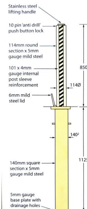
Poste de segurança **Rhino-Bollard Cullian** para ambientes de alto risco. Disponível na maioria das cores RAL. Altura: 850 mm. Diâmetro: 114 mm. Comprimento da haste: 1125 mm. Peso: 66 kg. Peso operacional: 7 kg. Com mola a gás.
