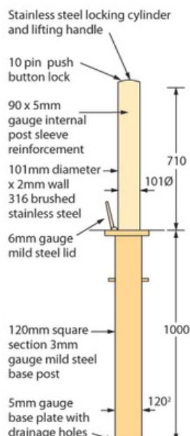
Borne d'arrêt **Rhino-Bollard Corniche** pour risques de sécurité modérés. Disponible en acier inoxydable 316L brossé et laqué. Hauteur : 710 mm, diamètre : 101 mm. Longueur de la tige : 1000 mm. Poids : 40 kg. Poids en ordre de marche : 17 kg.
