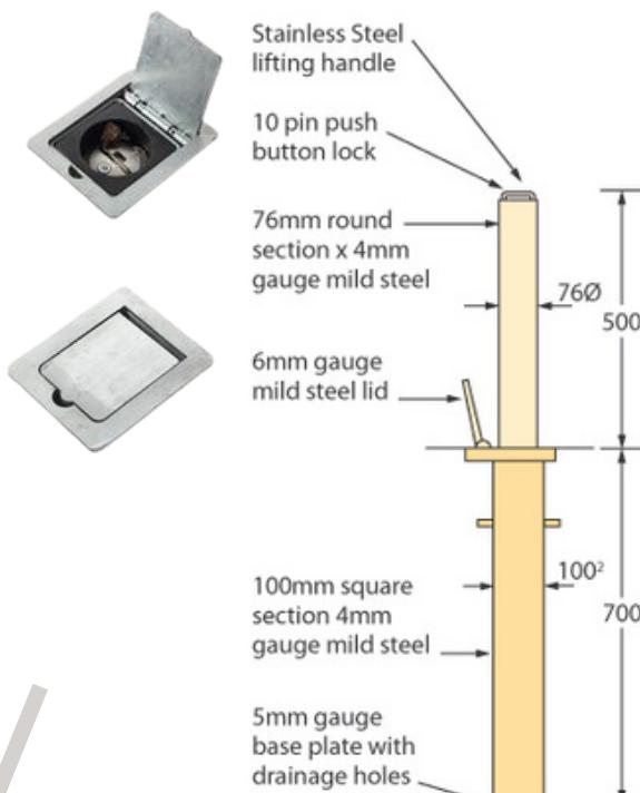
Borne de signalisation **Rhino Basic** pour un risque de sécurité faible. Disponible en bleu de signalisation, noir, gris ardoise et rouge. Hauteur de 500 mm. Diamètre de 76 mm. Longueur du mât de 700 mm. Poids de 22 kg. Poids en ordre de marche de 6 kg.
