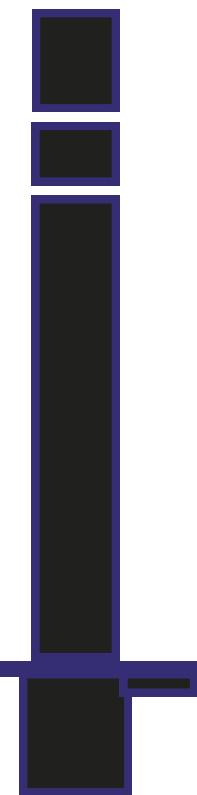
C'est un poteau démontable et flexible doté d'une mémoire de forme. Après avoir été déformé, il retrouve sa configuration d'origine.
