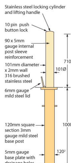
**Rhino-Bollard Corniche** für ein mittleres Sicherheitsrisiko. Erhältlich in gebürstetem und klar lackiertem Edelstahl 316L. Höhe 710 mm, Durchmesser 101 mm. Schaftlänge 1000 mm. Gewicht 40 kg. Betriebsgewicht 17 kg.
